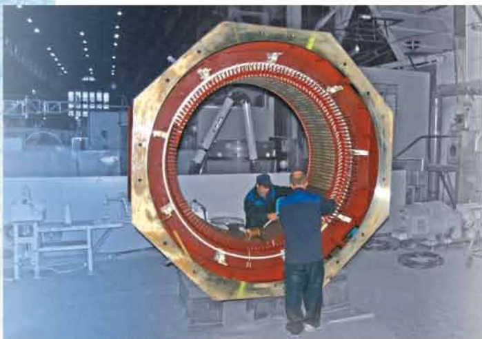
Статор двухскоростного асинхронного электродвигателя 4АВД 215/59-16-20 1600/1000 кВт, 6 кВ, 375/300 об/мин
