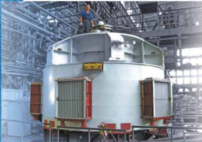
Вертикальный синхронный двигатель ВДСМ 375/105-24 12500 кВт, 10 кВ, 250 об/мин
